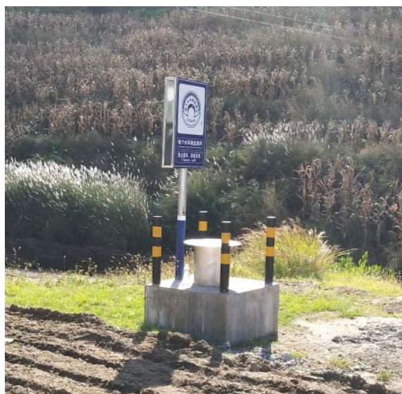
尾矿库左岸坝肩地下水监测井
